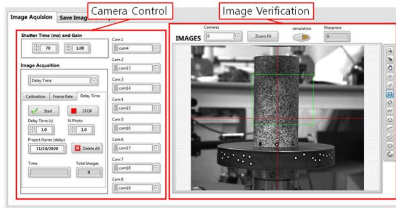
Fig. 13. LabVIEW™ 프로그램을 사용하여 다중 DIC 시스템 제어
