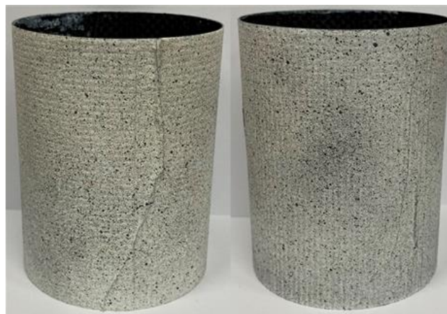
Fig. 12. 스페클 패턴을 도포한 복합재 원통형 구조물 시편
