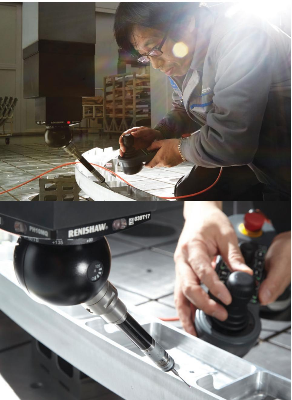
3차원 측정 장비인 CMM 장비를 이용해 가공 완료된 제품 및 치공구의 윤곽과 정밀 훌 위치를 측정하는 정밀 공정을 수행하는 것이 2조의 주요 업무다.
