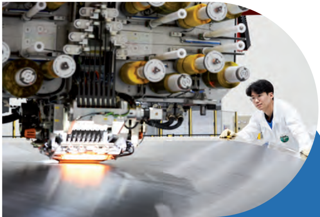
1 KAI의 복합재 자동 척증 장비. KAI에서는 현재 KF-X에 들어가는 각종 복합재 부품을 개발하고 있다.
