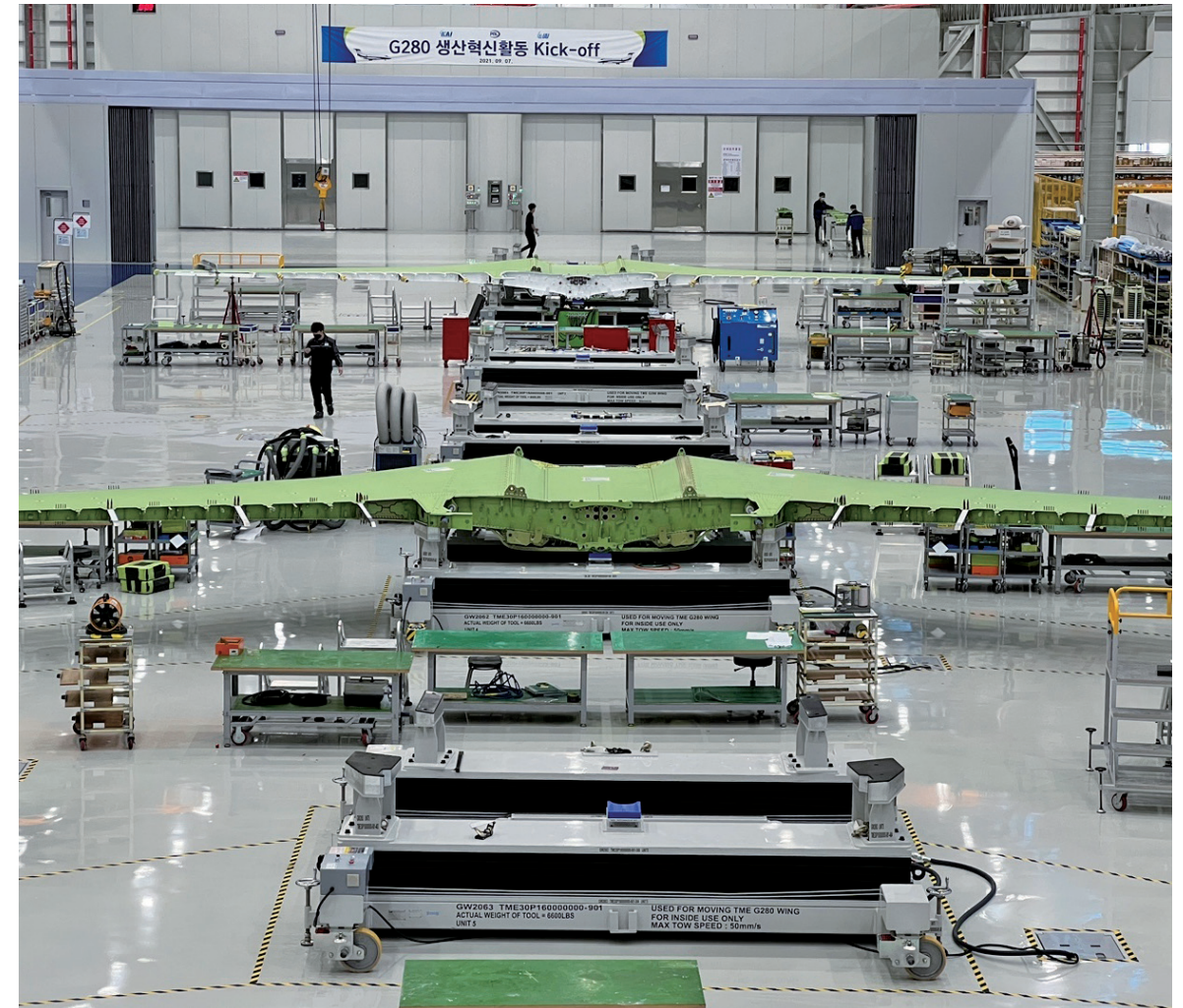
KAI의 제조혁신활동 지원을 통해 진행되는 외주 협력사의 G280 레이다운 툴(Lay Down Tool) 전경
