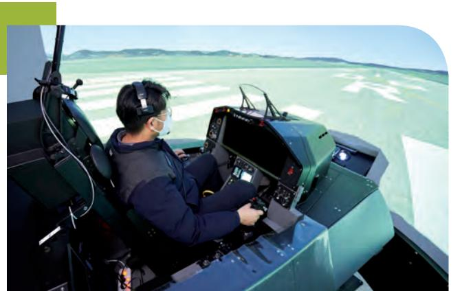
HQS를 활용한 비행제어 시험은 크게 시험실 시험과 지상시험, 그리고 비행시험으로 구분된다. 시험실 시험으로부터 비행시험으로 갈수록 실제 항공기의 운용 및 비행환경에 가깝게 시스템 환경을 모사한다.
