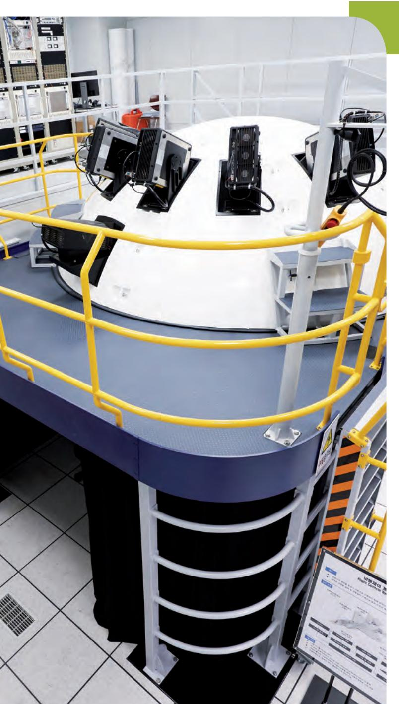
KF-X의 마무리 조립이 한창인 가운데 올 상반기 를아웃 행사 를 앞두고 기대가 높아지고 있다. 기체조립과는 별개로 KF-X 의 각종 시스템을 구축하고 검증하기 위한 다양한 시뮬레이션 툴 개발도 이어지고 있다. 그 중 하나가 KF-X의 비행성능과 비 행안정성을 가늠하기 위한 조종성 평가 시뮬레이터 HQS다.
