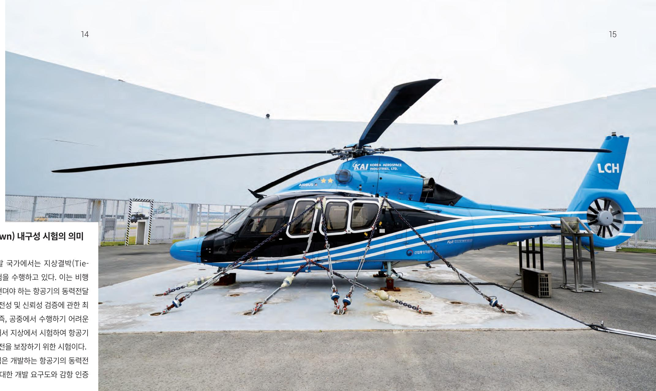
입증을 위해 수행된다. 내구성 시험은 지상결박 형태에서 약 1년 정도가 소요되는 장기간의 프로젝트이며, 시험체 (GTV : Ground Test Vehicle)에 가혹한 하중을 부과하는 위험도가 높은 고난도의 시험이다. 또한 고가의 시험체, 운용인력 및 시험장 설비 구축 등 수백억 원 단위의 예산이 투입되는 시험이다. 따라서 적절하지 못한 절차의 내구성 시험은 일정과 비용 측면에서 돌이킬 수 없는 일정 연과 추가 예산이 소모 될 수 있다. 이런 쉽지 않은 시험을 기간 내 완료한 것은 수리온 지상결박 내구성 시험 과정에서 얻은 노하우와 각 계통 담당자들의 혼신 덕분이라 할 수 있다.
