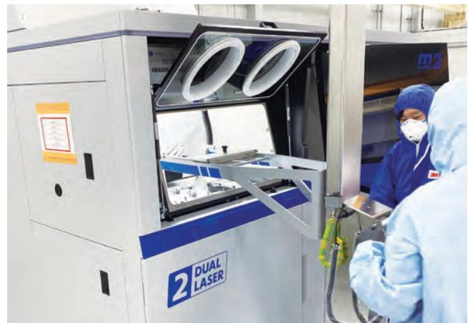
KAI가 적층 제조공정 관련 인프라를 사내에 구축한다. 이를 위해 올해 5월 AM(Additive Manufacturing, 적층 제조) 장비 설치 완료를 시작으로 오는 7월까지 응력제거를 위한 열처리실, 절단 장비(EDM, Electrical Discharge Machine), 후처리실, 표면 처리(Sanding Blaster) 장비 등 관련 공정 장비를 추가 설치할 예정이다.
