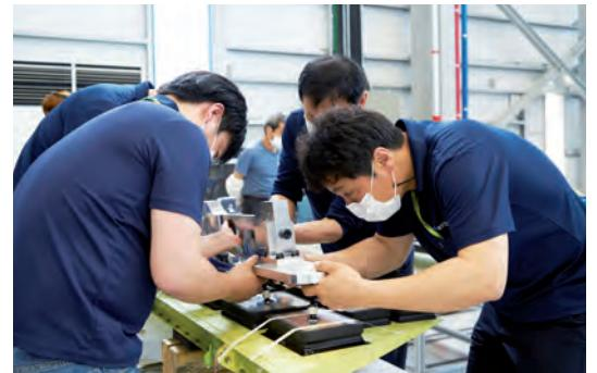
시험체에 하중 패드 (Load Pad)와 휘플트리 (Whiffletree)를 설치
