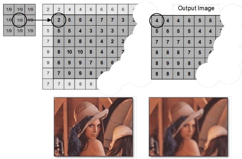
Fig. 15. Image filtering
