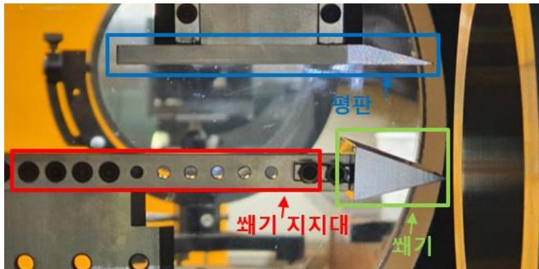
Fig. 4. 평판과 쇄기모델이 시험부에 장착된 모습
