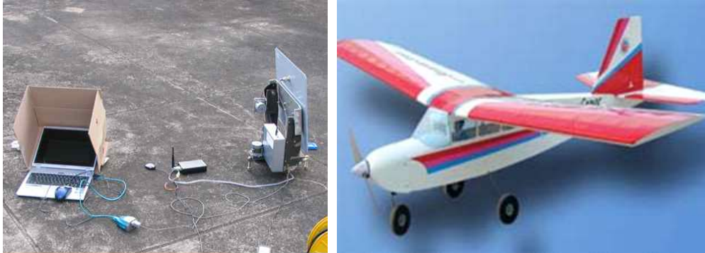
그림 2.2-1 안테나 시스템과 실험에 사용한 GPS가 설치된 무인 항공기(Frontier 40)
