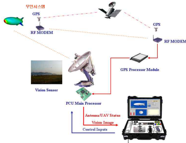
그림 2.3-4 GPS와 영상 센서를 이용한 안테나 시스템
