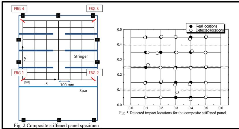
실 구조물에 위한 충격 위치 검출 알고리즘을 개발하기 위해 복합재 단순 평판, 복합재 보강 패널에 대한 충격 위치 검출 시험을 수행하였다. 기존의 연구에 비해 시스템 구성이 간단한 (주) 파이버 프로 상의 고속 FBG 시스템을 이용하여  $400 \times 400 \text{ mm}^2$ 의 영역에 대해 4 개의 FBG 센서가 있는 하나의 광섬유 라인을 통해 충격 신호를 취득하였으며 신경회로망 학습을 통해 성공적인 위치 검출을 수행하였다. 이 과정에서 개발된 충격 위치 검출 알고리즘을 실제 크기의 복합재 무인기 날개 윗 면에 적용하였고, rib과 stringer 등이 포함된 복잡한 영역임에도 불구하고 작은 오차 범위에서 충격 위치가 검출되는 것을 확인할 수 있었다.
