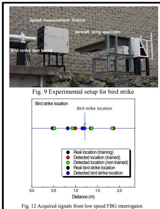
복합재 항공기, 특히 무인기에 대한 충격 모니터링 기법에는 조류충돌에 의한 충격 이벤트 감지도 포함되어야 한다. 조류충돌의 발생 빈도가 높은 날개 앞전(leading edge)에 충격 거동 FBG 센서를 부착하고 조류를 모사하기 위해 젤 타입의 충격체를 사용하여 조류충돌 모사 시험을 수행하였다. 총 3 번의 시험을 수행하였고, 광섬유 센서 라인의 파손 없이 조류충돌에 의한 신호 획득에 성공하였다. 획득된 신호를 이용하여 조류충돌이 발생한 지점을 근사한 오차로 예측할 수 있었다. 또한 앞전 스파에 부착된 정적 거동 FBG 센서를 통해서 취득한 신호를 통해서 주파수 대역에 따른 조류충돌 신호의 특성을 비교하였다.
